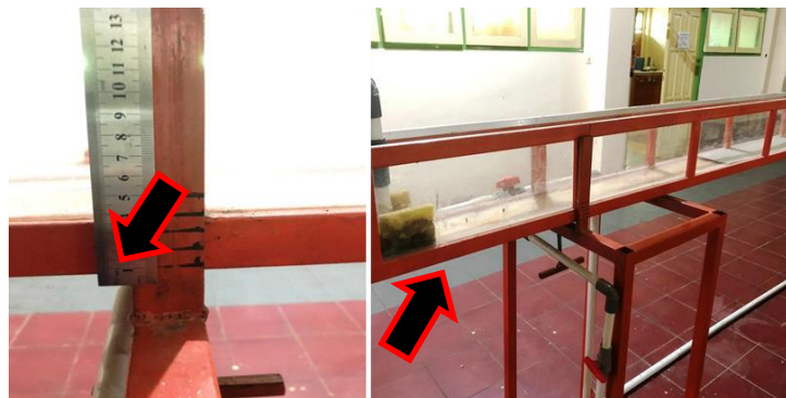
Gambar 2. Tuas pengatur kemiringan saluran Sumber : Data Pribadi, 2024
