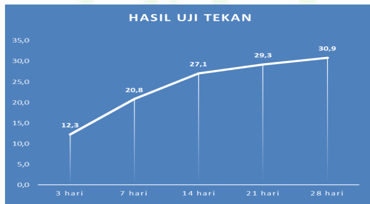
Gambar 3. Hasil Kuat Tekan Beton dengan Suhu Air Normal
