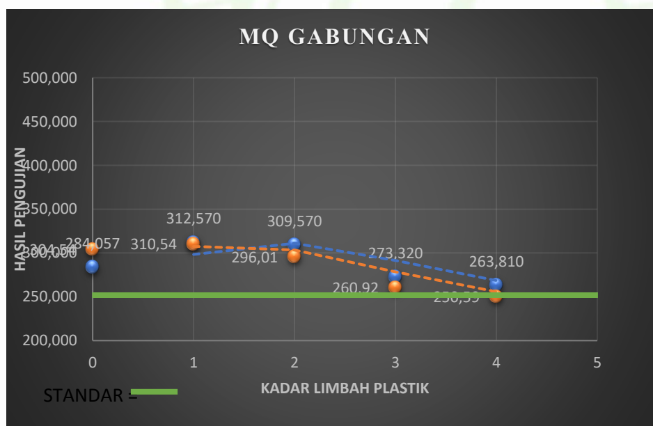
Gambar 6. Nilai marshall quetiont gradasi halus dan kasar pada penambahan limbah plastik PET Sumber: Hasil Perhitungan, 2025
